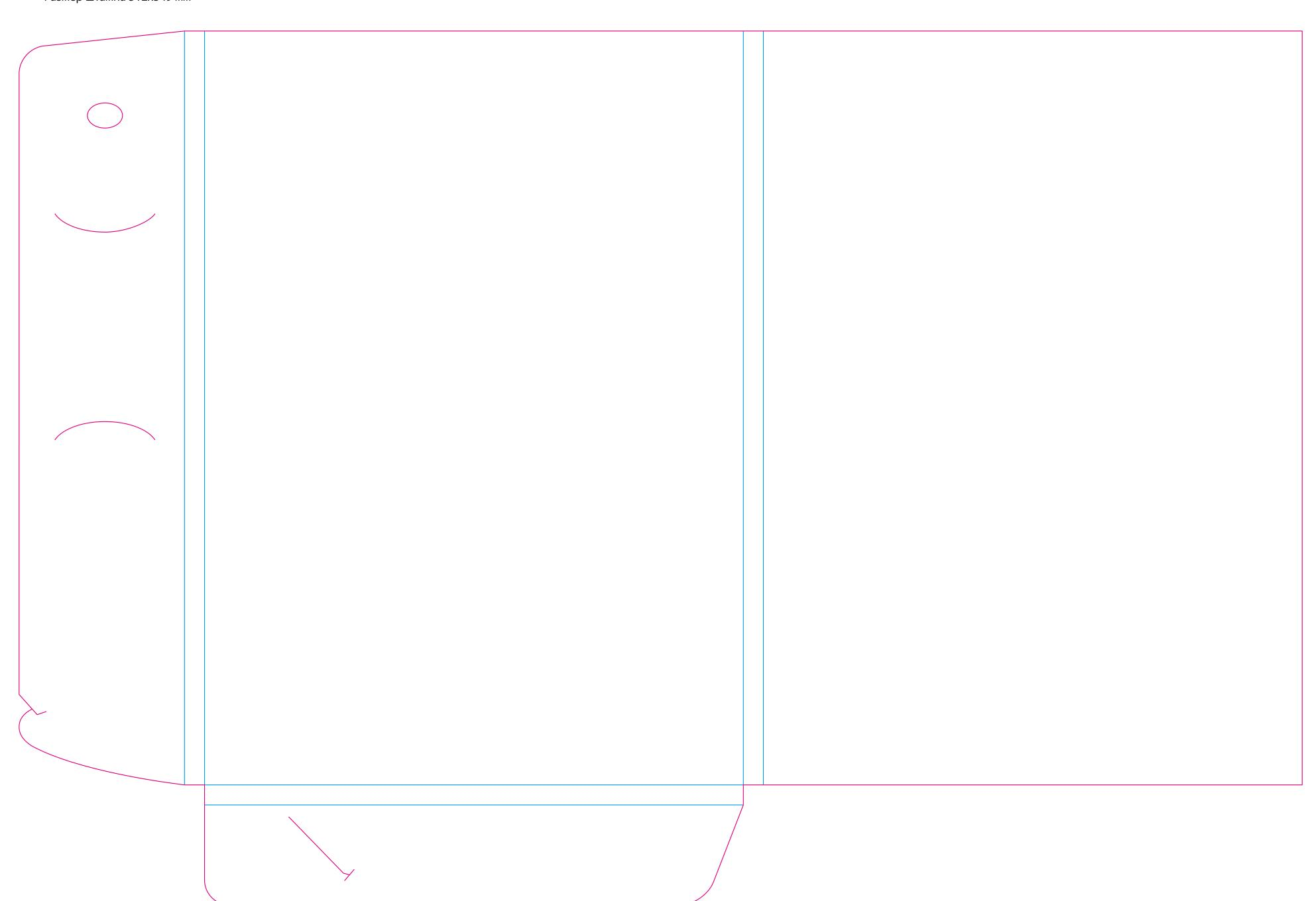
Тигель Штамп № 211 Пакет 680х480 (Половинка) Развертка половинки пакета 695х555 мм Размер штампа 705х565 мм
